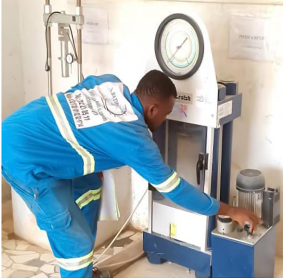
Presse à béton
