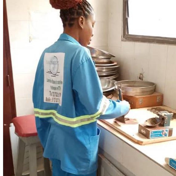
Equipement d'essais de limites d'Atterberg
