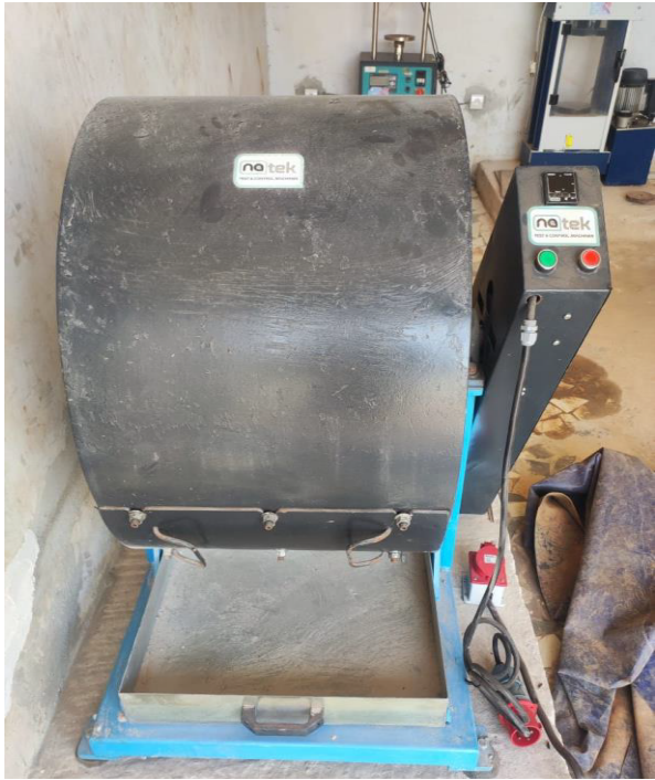
Equipement d'essai Los Angeles
