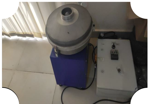
Centrifugeuse (Equipement d'extraction de liant)
