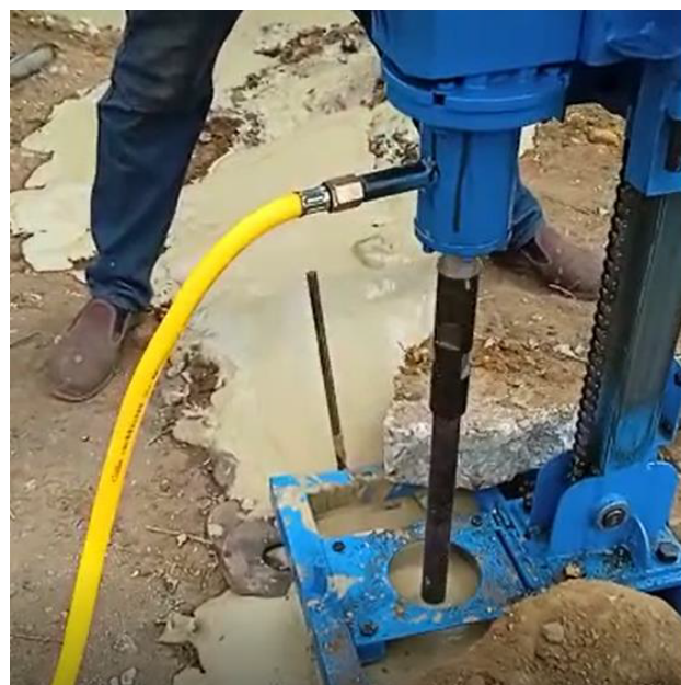
Tarière mécanique de type Minuteman
