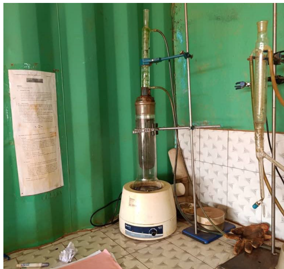
Equipement d'extraction de liant (Méthode de Kumagawa)
